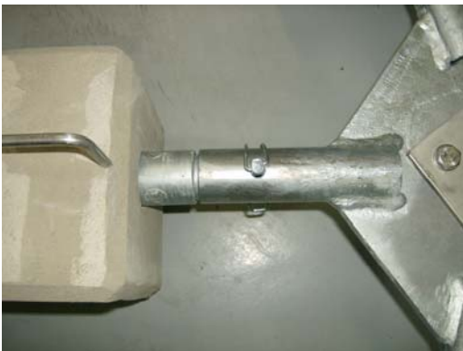
Abb. 12: Verbindung mittels Klappstecker
