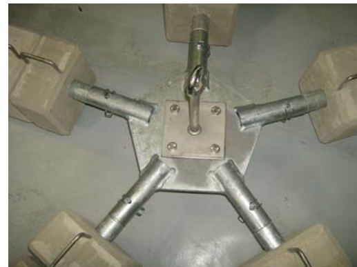
Abb. 13: komplette Verbindung der Arme
