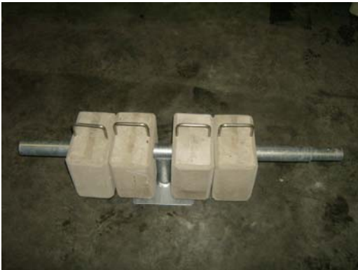
Abb. 4: Einschieben der Betongewichte
