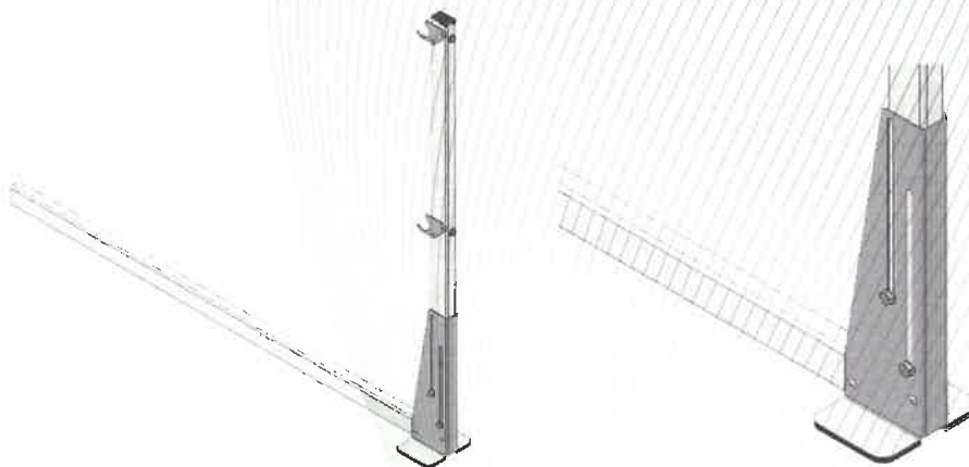
Bilder 9 - 10: LUX-top® G-T HA Grundelement mit Detailansicht zur Höhenverstellung
