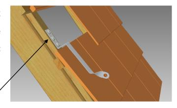
Schraubenlänge **L** wird in Abhängigkeit vom vorhandenen Dachaufbau festgelegt.
