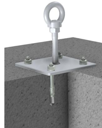
1. Bohrlöcher mit Bohrer Ø 10 mm , ab Oberkante Fußplatte 75 mm tief bohren.
