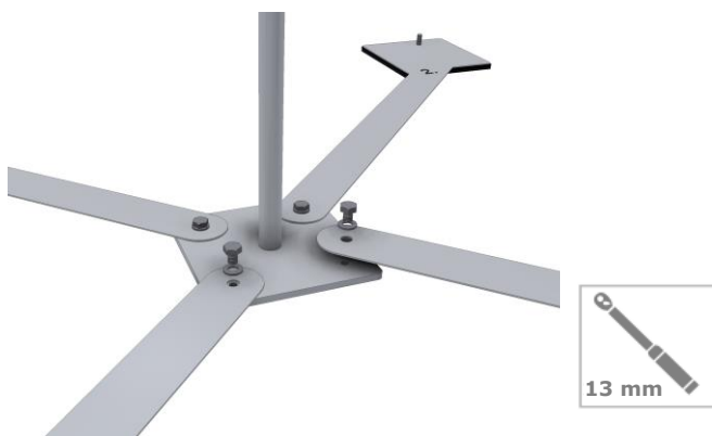
Abb. 3: Verschraubung der Standfüße
