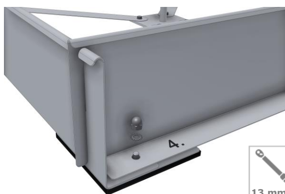
Abb. 6: Befestigung der Randeffassung
