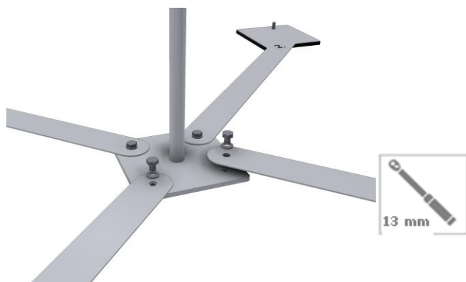
Figure 3 : vissage des pieds d'appui
