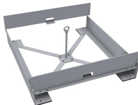
Abb. 5: Einstecken der oberen Seitenteile
