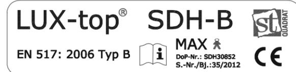
Die Lesbarkeit dieser Produktkennzeichnung ist nach erfolgter Montage sowie bei der vorgeschriebenen jährlichen Kontrolle zu prüfen!
