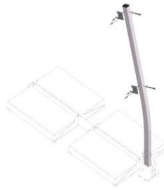
GE-11 LUX-top® G-T Geländerpfosten gebogen Art.-Nr.: 87287
